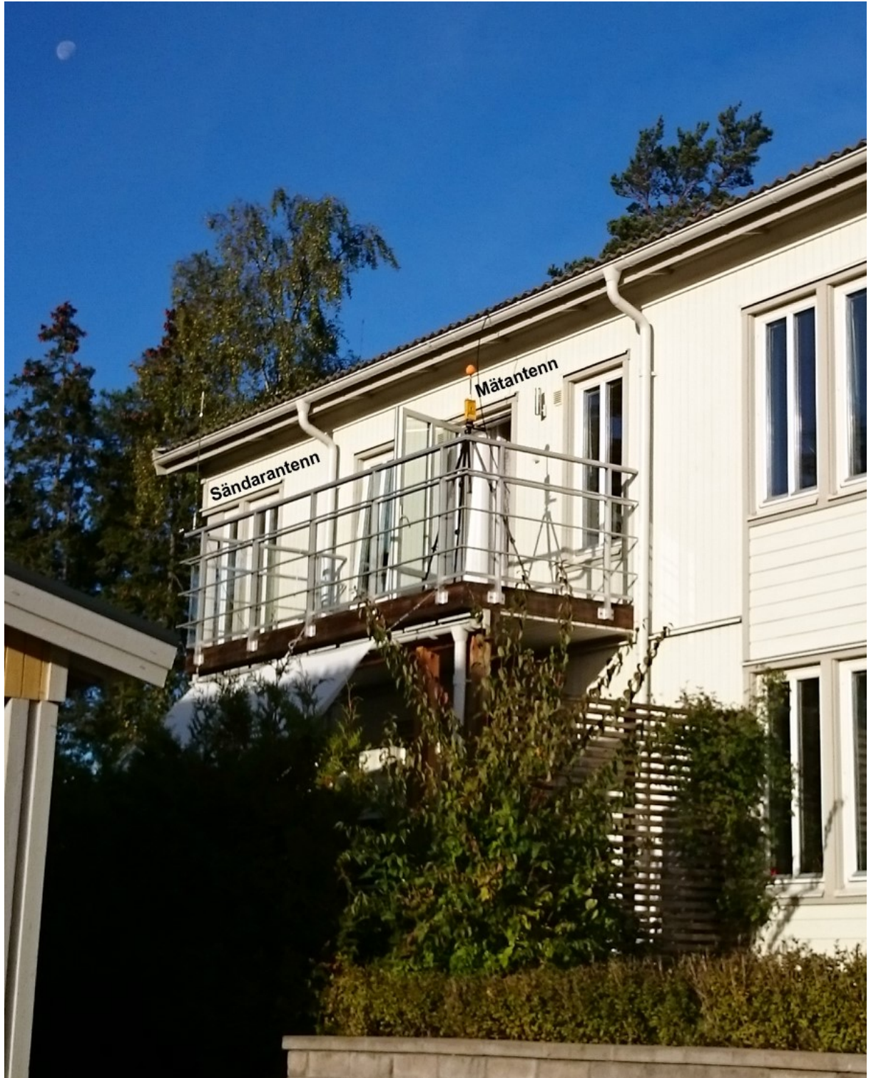
Bild 1. Mätuppställning på balkongen, typfall 1 och 3.
