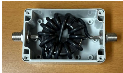
Common-mode drossel med RG223 koaxialkabel
