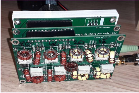
Tranceivern är uppbyggd som en "macka" med tre stackade kort.
