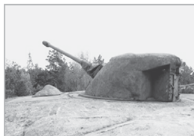
Kanonen kunde avfira 35 skott (ett skott vägde cirka 35 kg) i minuten och hade en räckvidd på 20 kilometer
